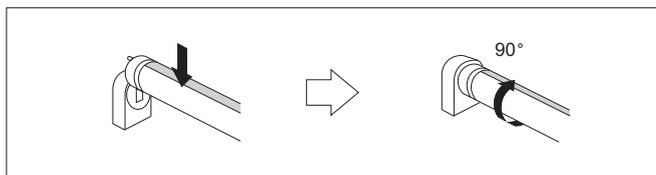
Schritt 2&3: Entfernen Sie die herkömmliche Röhre durch eine 90° Drehung
