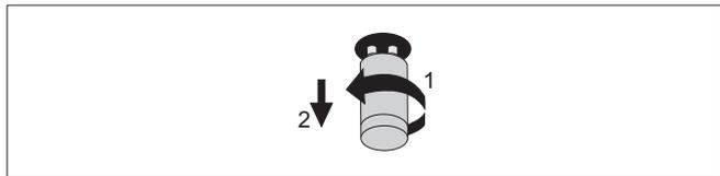
Schritt 6: Setzen Sie die MEGAMAN® T8 LED-Röhre in den Leuchtensockel
