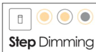
Die Leuchte verfügt über eine 3-fache-Dimmfunktion für helles Licht und dezente Grundbeleuchtung. Die Dimmeffekte sind mit jedem Lichtschalter- bzw. Schaltimpuls schaltbar.
